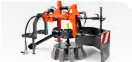
Zapfwellenbetriebene Wildkrautbürste zum gründlichen Entfernen von Unkraut und Schmutz aus Rinnen, von Gehwegen und an Bordsteinen. Der Bürstenwinkel ist vom Fahrersitz aus einstellbar. Durchmesser 50 cm. Erfordert Hydraulikkitt und Heckgewicht.
