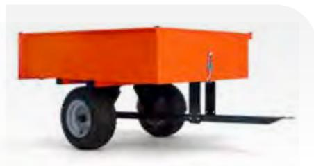
Geräumiger Anhänger aus robustem Stahl. Kippbar mit klappbarer Heckklappe für einfaches Be- und Entladen. Lademaße (L × B × H) 123 × 90 × 30 cm.
