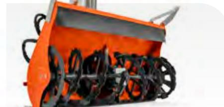
Hocheffiziente zweistufige Schneefräse mit Zapfwellenantrieb. Erfordert Hydraulikkit und Heckgewicht. Arbeitsbreite 120 cm, Auswurfrotation 300 Grad. Nur für den Einsatz mit dem P 525DX und P 535HX empfohlen.
