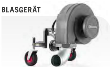
Zapfwellenbetriebenes Bläsergerät zum Säubern von großen, offenen Flächen. Kraftvolles, geräuscharmes Gebläse mit einem Luftstrom von 80 m<sup>3</sup>/min. Vom Fahrersitz aus verstellbarer, 360 Grad Luftauslass. Erfordert Hydraulikkit.
