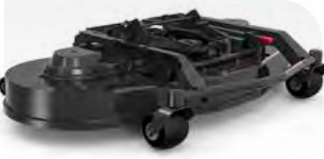
Ein robustes, 137 cm breites Mähdeck mit Heckauswurf. Optimal für den Einsatz mit den Husqvarna P 524X EFI-Modellen. Hohe Produktivität dank größerer Schnittbreite und Mähgeschwindigkeit im Vergleich mit Husqvarna Combi Decks. Inklusive Mulcheinsatz.
