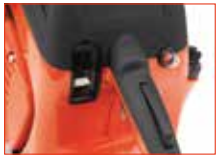
Touch&Stop Einhebelbedienung mit klaren Stellungen für Kaltstart, Betrieb und Stopp.
