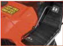
Stufenloses Hydrostatikgetriebe für Rückwärtsfahrt mit einfacher Fußhebelbedien ung.
