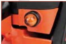
Starthilfe Primer: Starthilfe durch manuelle Kraftstoffpumpe. Motor springt mit wenigen Zügen an.
