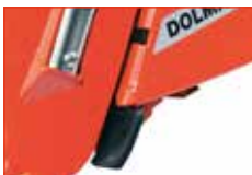
Optimaler Spanauswurf verhindert Verstopfung, auch bei langen Spänen.
