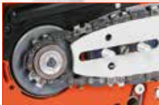
Außen liegendes Kettenrad für unkomplizierte und einfache Kettenmontage.
