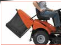
Einfache Grasfangkorbentleerung vom Fahrersitz aus.
