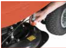
Wasseranschluss für schnelle Mähdeckreinigung.
