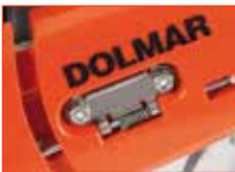
Markierung für korrekte Keilriemenspannung .
