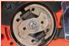
Fliehkraftkupplung in Profiqualität für gute Kraftübertragung auf die Sägekette.
