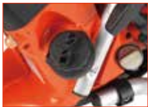
Betanken rechts über senkrechten Stutzen.
